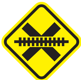
A-39 Passagem de nível sem barreira
